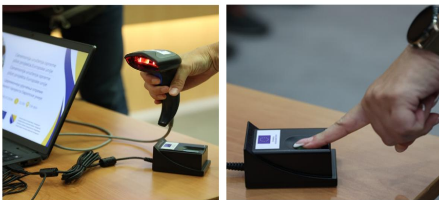
Slika 9. Set opreme za biračko mjesto: laptop, bar kod skener za dokumente, skener otisaka prstiju
