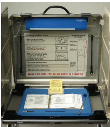
Sustav glasanja na principu bušenih kartica
