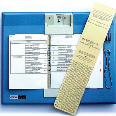
Sustav glasanja na principu bušenih kartica
